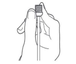
Die Schraubkappe mit durchgeführtem Drahtseil am Deckenbefestiger fest aufschrauben.
