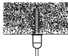
Verschrauben Sie die mitgelieferten Drahtseilhalter „Düse“ in die vormontierten Einschlaganker; drehen Sie diese vollständig ins Gewinde.
